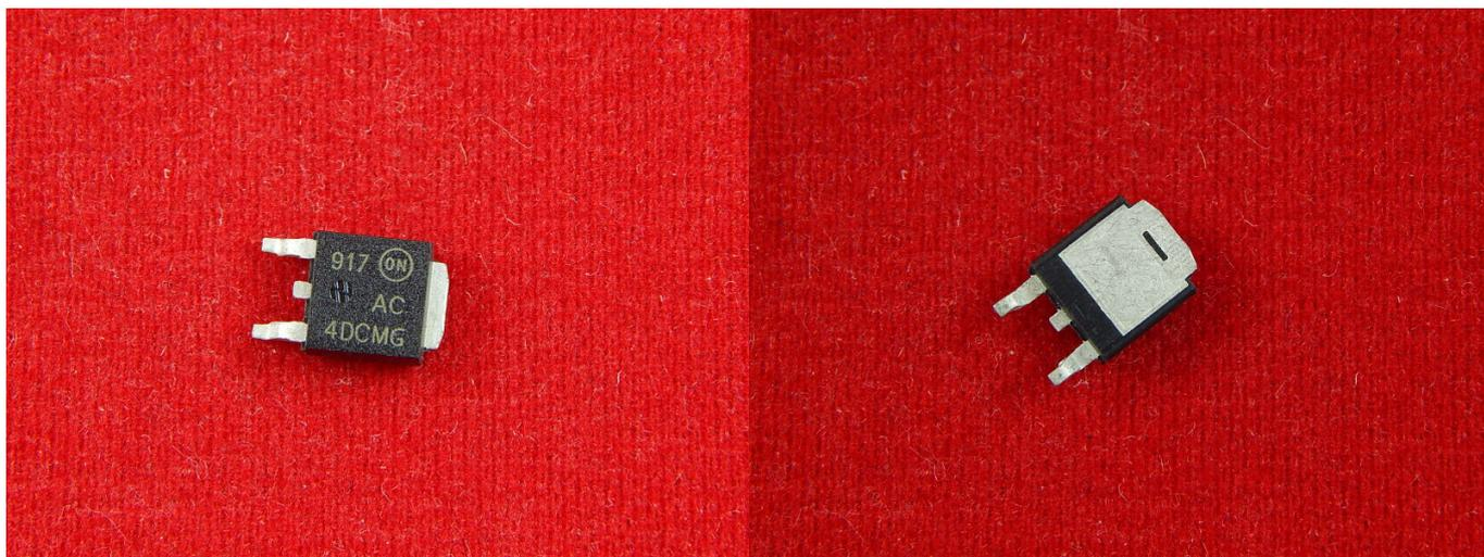
Симистор - полупроводниковый прибор, являющийся разновидностью тиристорov и используемый для коммутации в цепях переменного тока. В электронике часто рассматривается как управляемый выключатель.
