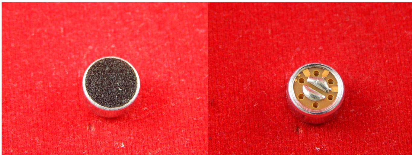
Микрофонные капсюли - это закрытое устройство в корпусе которого происходит преобразование акустических сигналов в электрические, с последующей передачей последних с линию, сеть, эфир или на звуко-записывающее или звукоусилительное устройство.
