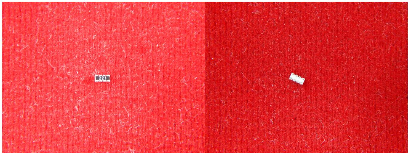
SMD резисторы - это миниатюрные резисторы, предназначенные для поверхностного монтажа.
