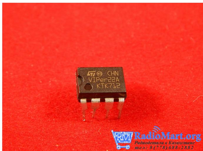
Контроллер для импульсных источников питания 730V DIP8
