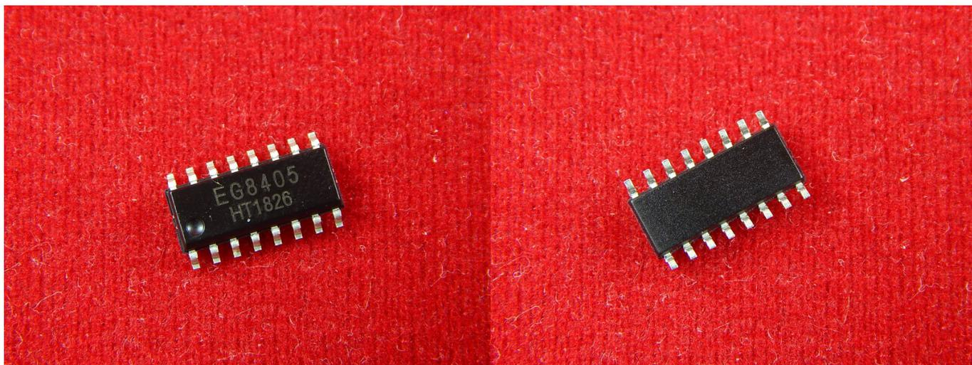
EG8405 - это усилитель мощности класса D для стереофонического выходного фильтра с функцией защиты от искажений и ультранизким ЕМІ. Напряжение питания 5В, THD+N=10%, 4 Ом с выходной мощностью до 3.2 Вт в условиях нагрузки эффективность производительности 88%, сопоставима с усилителями класса АВ.
