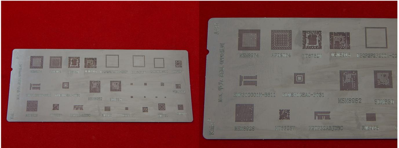
Термин реболинг — это замена шариков припоя, которые располагаются под электронными BGA-компонентами.
