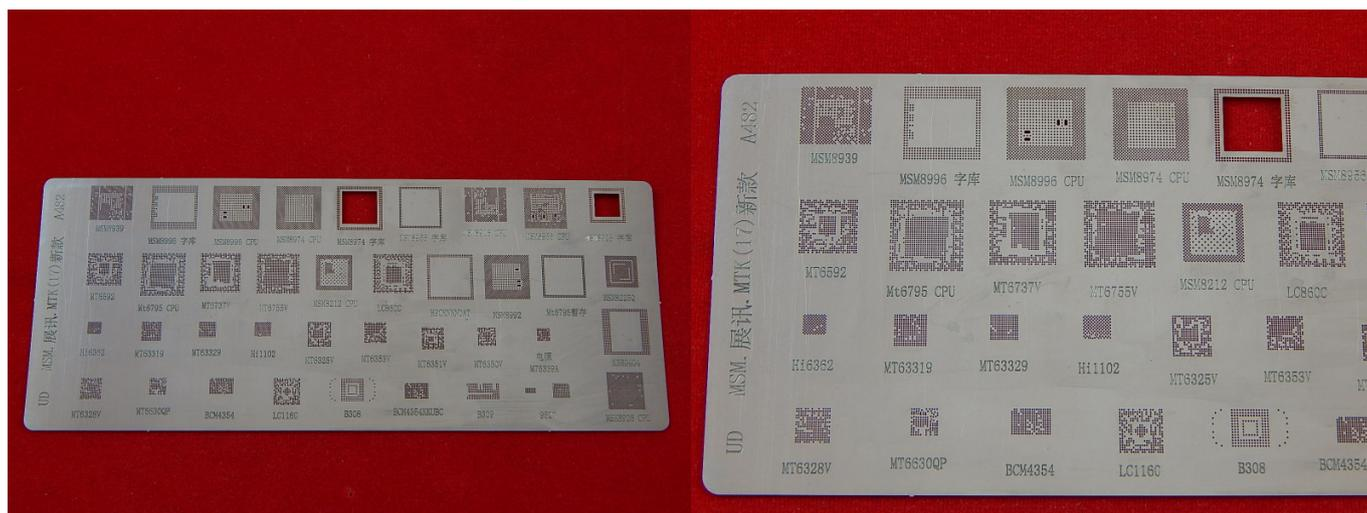
Термин реболлинг — это замена шариков припоя, которые располагаются под электронными BGA-компонентами.
