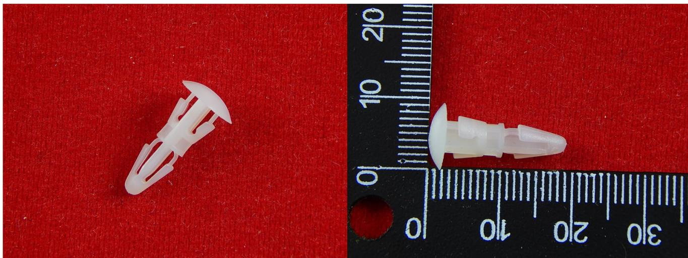
Стойка для печатных плат представляет из себя сравнительно небольшое приспособление, служащее для закрепления плат в корпусе прибора и для их расположения в несколько ярусов, находящихся один над другим.
