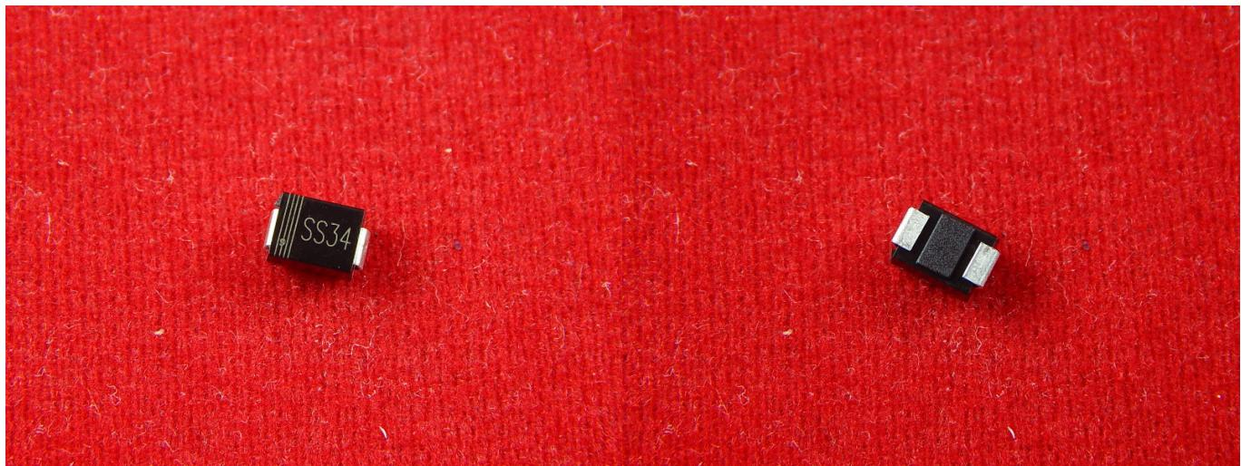
Диод SS34 выпрямительный с барьером Шоттки. Предназначен для применения в быстродействующих импульсных устройствах с максимально допустимый средним прямым током 3.0А. На корпусе со стороны катодного вывода нанесена полоска. Корпус: литой пластиковый корпус DO-214AB.
