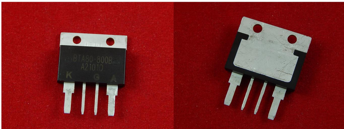
Тиристор ВТА80А-800В полупроводниковый, симметричный (симистор) для коммутации переменного тока и управления до 80А. Предназначен для применения в качестве переключающих элементов для устройств автоматического регулирования и коммутации цепей силовой автоматики. Маркировка тиристора указывается на корпусе.
