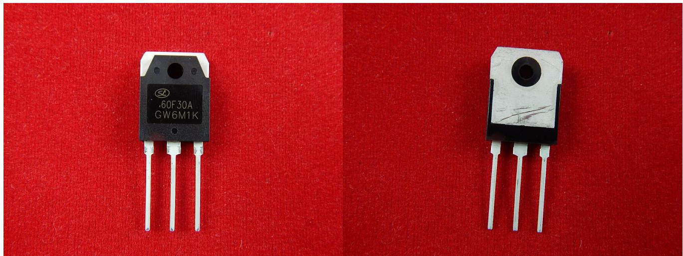
Диод – электронный прибор, основным функциональным свойством которого является низкое сопротивление при передаче тока в одну сторону и высокое при передаче в обратную.
