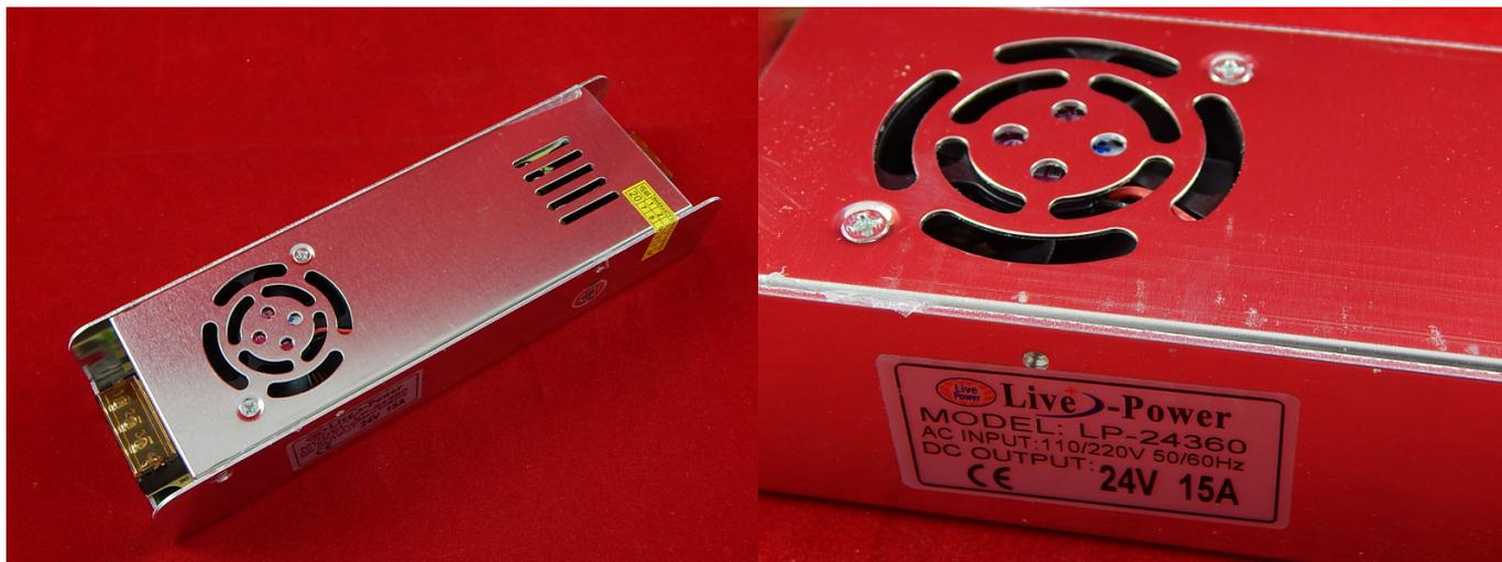
Импульсный источник питания - это инверторная система, в которой входное переменное напряжение выпрямляется, а потом полученное постоянное напряжение преобразуется в импульсы высокой частоты и установленной скважности, которые как правило, подаются на импульсный трансформатор.
