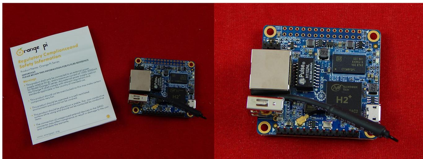
Orange Pi Zero LTS — это одноплатный компьютер на базе SoC Allwinner H2+: 4 ядра ARM Cortex-A7 с тактовой частотой 1.2 ГГц и GPU Mali400 MP2 с частотой 600 МГц. Объем оперативной памяти — 512 Мбайт DDR3 SDRAM. Orange Pi Zero LTS поможет разработчикам в реализации различных проектов в области Интернета вещей (IoT).
