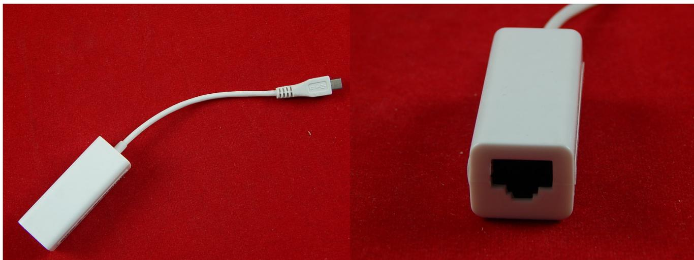
Используется как дополнительный или основной сетевой Ethernet адаптер. Необходимый драйвер содержится в стандартном наборе большинства операционных систем и не требует дополнительной установки.
