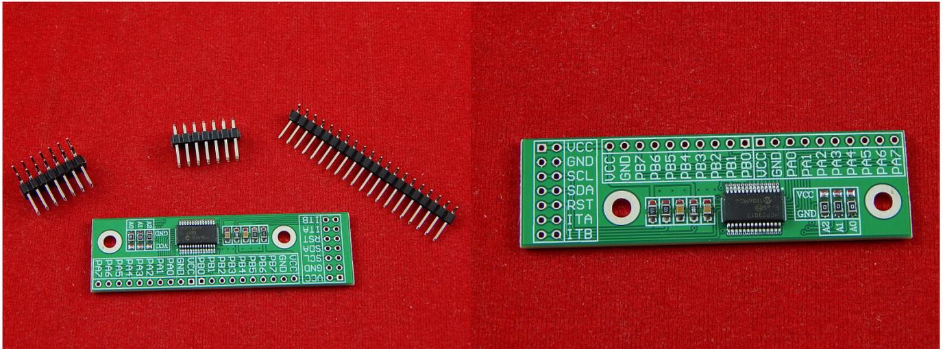
Модуль построен на базе чипа MCP23017 с поддержкой высокоскоростного интерфейса I2C. Берет на себя роль конвертера сигналов: расширяет число портов ввода/вывода у микроконтроллеров для подключения различных электронных модулей и устройств (например, дисплеев). Гребенки контактов идут отдельно с модулем (их нужно будет припаять к контактам на плате модуля).
