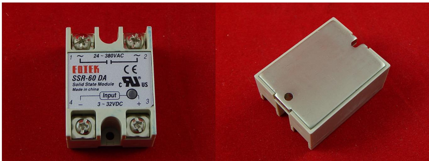
Твердотельное реле — электронное устройство, являющееся типом реле без механических движущихся частей, служащее для включения и выключения высокомощной цепи с помощью низких напряжений, подаваемых на клеммы управления.
