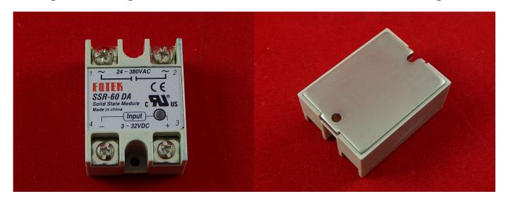
Твердотельное реле — электронное устройство, являющееся типом реле без механических движущихся частей, служащее для включения и выключения высокомощностной цепи с помощью низких напряжений, подаваемых на клеммы управления.
