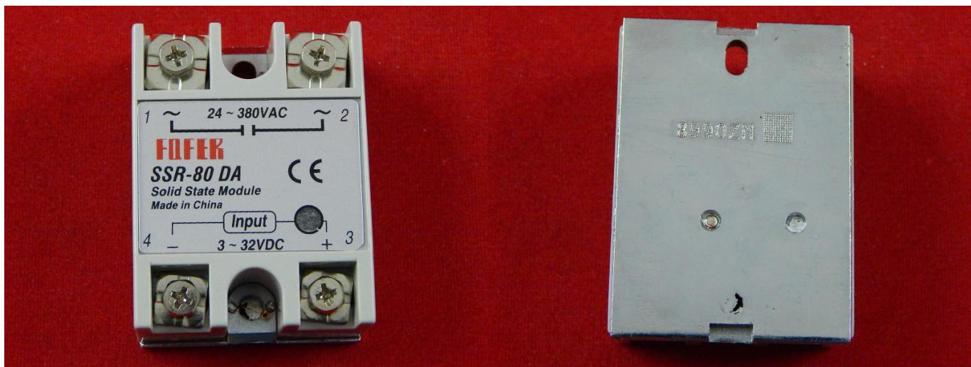
Твердотельное реле - это электронное устройство, являющееся типом реле без механических движущихся частей, служащее для включения и выключения высокомощной цепи с помощью низких напряжений подаваемых на клеммы управления.
