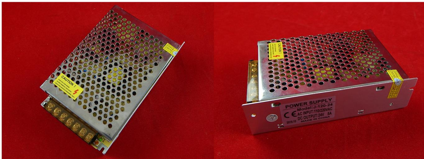
Импульсный источник питания - это инверторная система, в которой входное переменное напряжение выпрямляется, а потом полученное постоянное напряжение преобразуется в импульсы высокой частоты и установленной скважности, которые как правило, подаются на импульсный трансформатор. Импульсный блок питания S-120-24 выполнен в алюминиевом корпусе и имеет степень защиты IP20.
