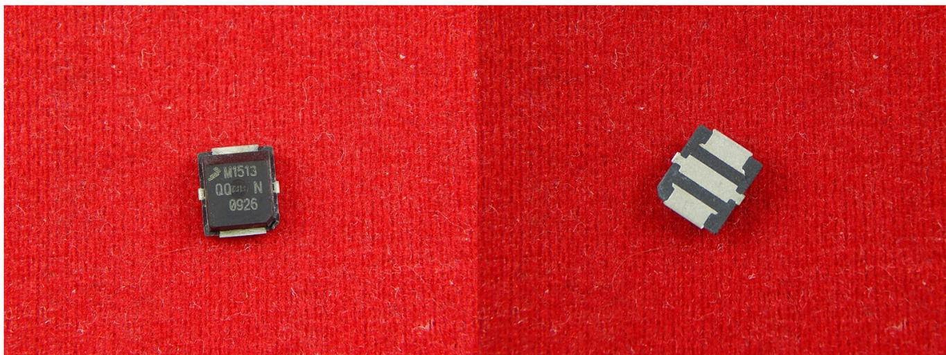
Транзистор – это электронный компонент, который управляет высоким током с помощью низкого. Транзистор еще можно назвать полупроводниковым триодом.
