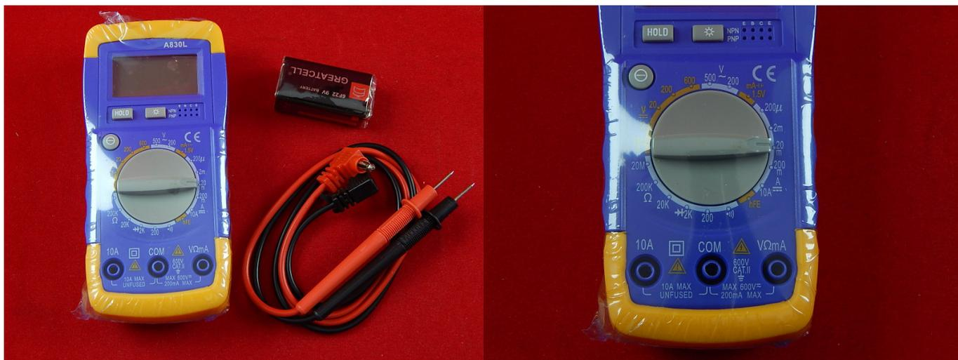
Мультиметр — комбинированный электроизмерительный прибор, объединяющий в себе несколько функций. В минимальном наборе включает функции вольтметра, амперметра и омметра.
