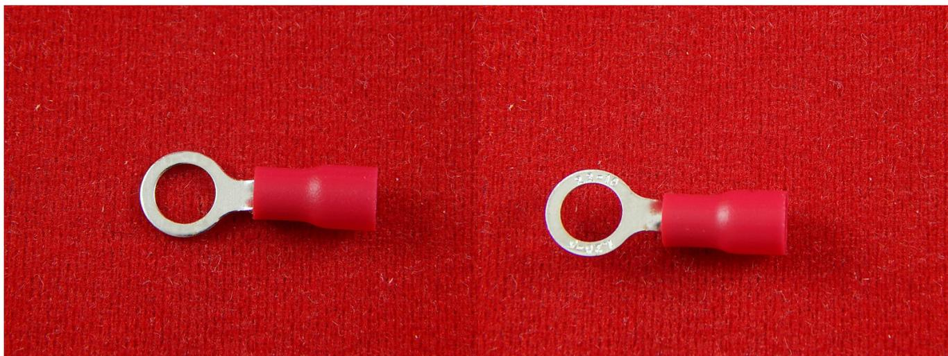
Наконечник кольцевой (под болт, винт) с изоляцией RVS1.25-5 применяется для оконцовки медных кабелей и проводов. Монтаж производится методом опрессовки.
