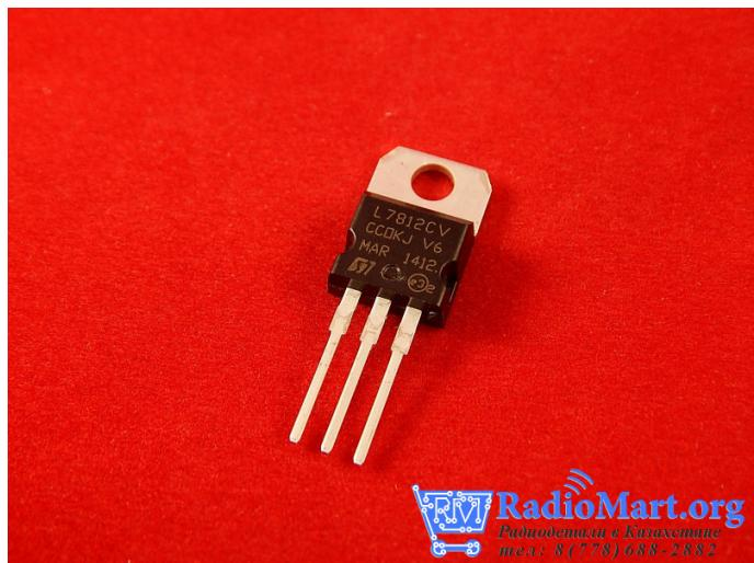
На выходе выдает ровные 12 Вольт, выдерживает хороший ток, особенно микросхемы в корпусе ТО220 при монтаже на радиатор.
