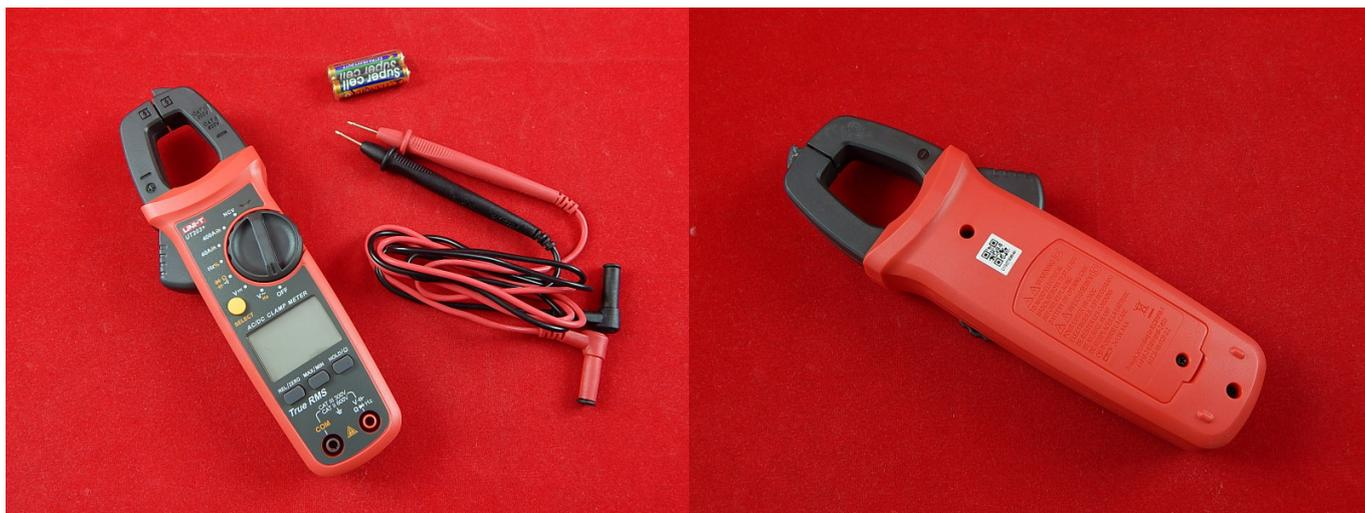
Токовые клещи модели UT203+ предназначены для выполнения точных измерений значений переменного тока до 400А (в поддиапазонах до 40А/400А, выбор требуемого поддиапазона выполняется в ручном режиме), напряжения AC/DC до 600 В, сопротивления до 40 МОм, ёмкости до 4мФ, частота до 10 МГц. Особенностью токоизмерительных клещей является разрешение 0,01 мА.
