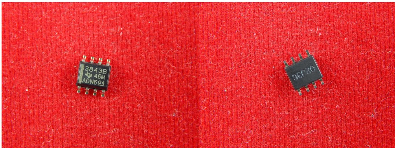
Интегральная схема - электронная схема произвольной сложности, изготовленная на полупроводниковой подложке и помещённая в неразборный корпус или без такового в случае вхождения в состав микросборки.
