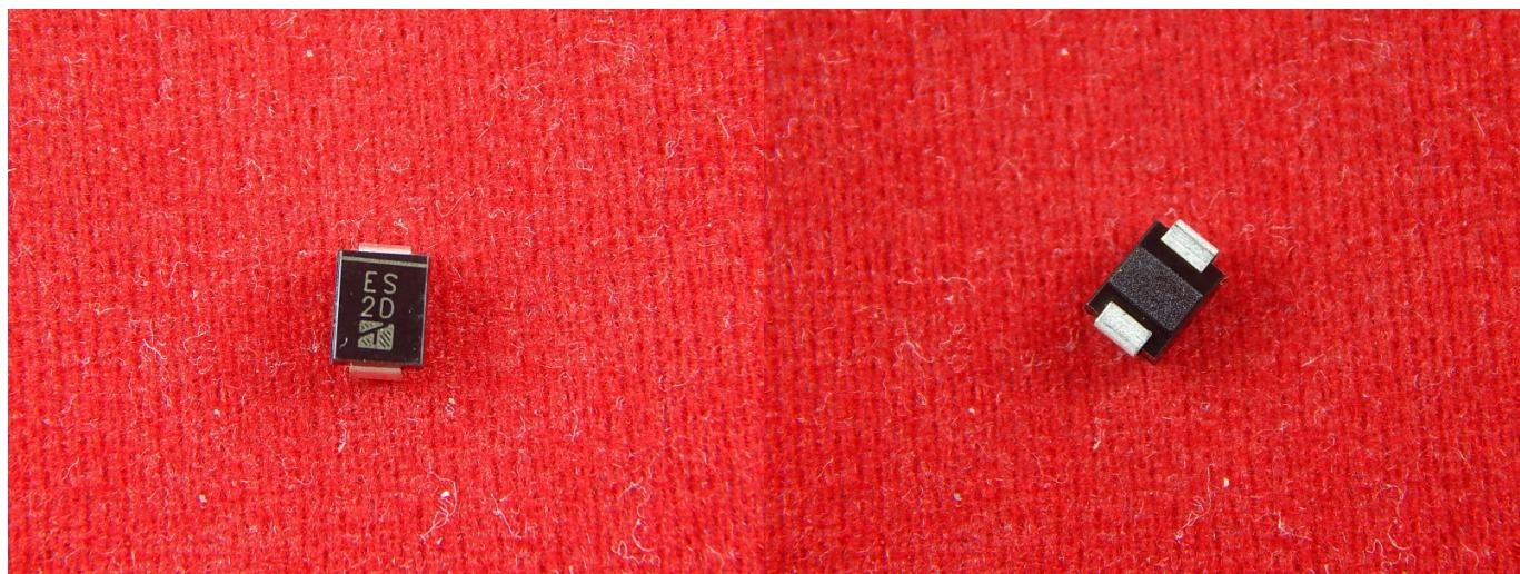
Импульсный диод - это диод с малой длительностью переходных процессов, предназначенный для применения в импульсных режимах работы.
