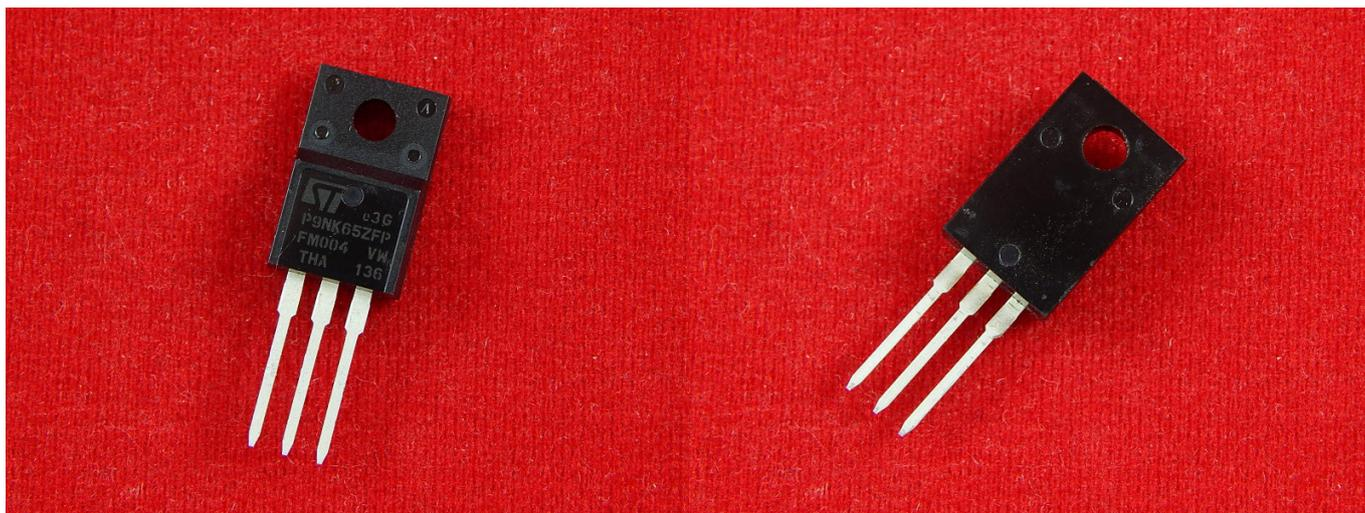
МОП-структура — полупроводниковая структура, применяемая при производстве микросхем и дискретных полевых транзисторов. Полупроводниковые приборы на основе этой структуры называют МОП-транзисторами, МДП-транзисторами или транзисторами с изолированным затвором.
