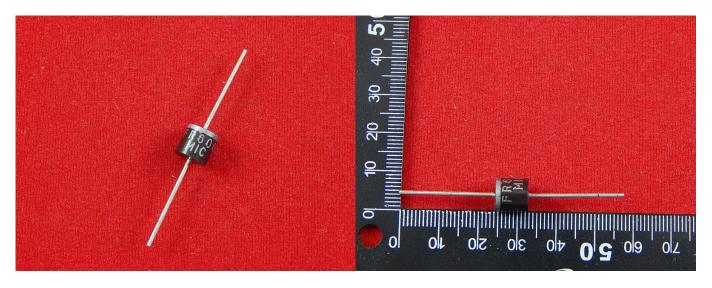
Диод — двухэлектродный электронный компонент, обладающий различной электрической проводимостью в зависимости от полярности приложенного к диоду напряжения. Диоды обладают нелинейной вольт-амперной характеристикой, но в отличие от ламп накаливания и терморезисторов, у диодов она несимметрична.
