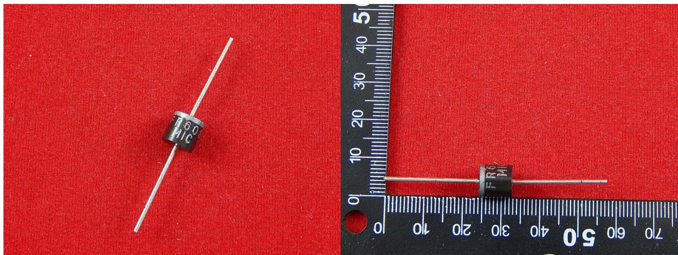
Диод — двухэлектродный электронный компонент, обладающий различной электрической проводимостью в зависимости от полярности приложенного к диоду напряжения. Диоды обладают нелинейной вольт-амперной характеристикой, но в отличие от ламп накаливания и терморезисторов, у диодов она несимметрична.
