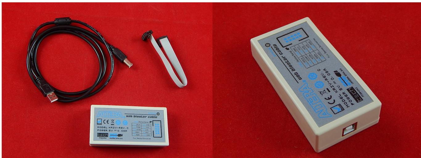
Программатор — аппаратно-программное устройство, предназначенное для записи/считывания информации в постоянное запоминающее устройство (однократно записываемое, ПЗУ, внутреннюю память микроконтроллеров и ПЛК).
