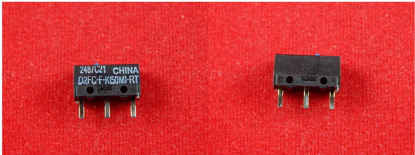
Микропереключатель — это устройство для передачи сигнала/ввода информации, элемент интерфейса человек-машина: элементарный физический механизм передачи электрического сигнала различным устройствам путём замыкания или размыкания двух или более контактов.
