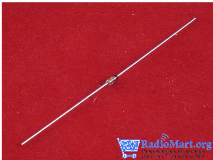
BZX55C11 - Стабилитрон это полупроводниковый диод, предназначенный для стабилизации напряжения. В отличии от обычных диодов, стабилитрон имеет достаточно низкое напряжение пробоя (при обратном включении) и что самое главное - может поддерживать это напряжение на постоянном уровне при значительном изменении силы обратного тока.
