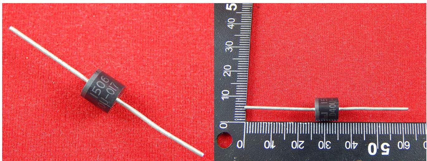
Серия SLD была разработана для обеспечения защиты от перенапряжения чувствительной электроники. Упакован в надежный осевой свинцовый корпус промышленного стандарта P600-2. Основная область применения серии SLD это защита от повреждений, вызванных переключением индуктивной нагрузки и сбросом нагрузки генератора.
