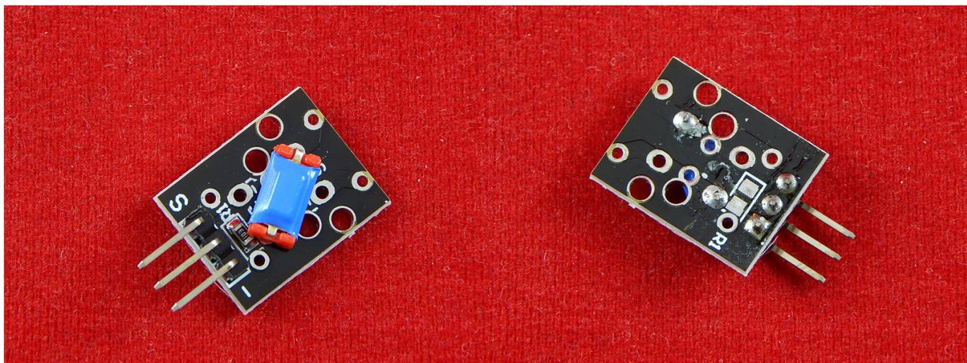
Применяется в системах контроля и безопасности. Модуль датчика наклона можно установить на крышках, дверцах, люках, закрывающих доступ в контролируемое пространство. Зарегистрировать малые углы наклона с его помощью нельзя.
