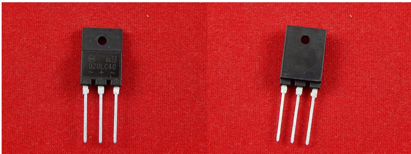
Диод с быстрым восстановлением - это диод, разработанный так, чтобы иметь как можно меньшее время восстановления, чтобы нежелательный сигнал не нарушал работу мощного или высокочастотного оборудования.
