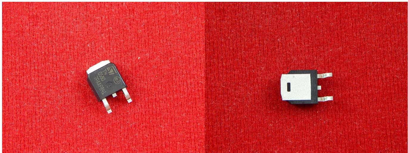
Симистор является полупроводниковым прибором. Его полное название – симметричный триодный тиристор. Его особенность – возможно проводить ток в обе стороны. Данный элемент цепи имеет три вывода: один является управляющим, а два других силовыми.
