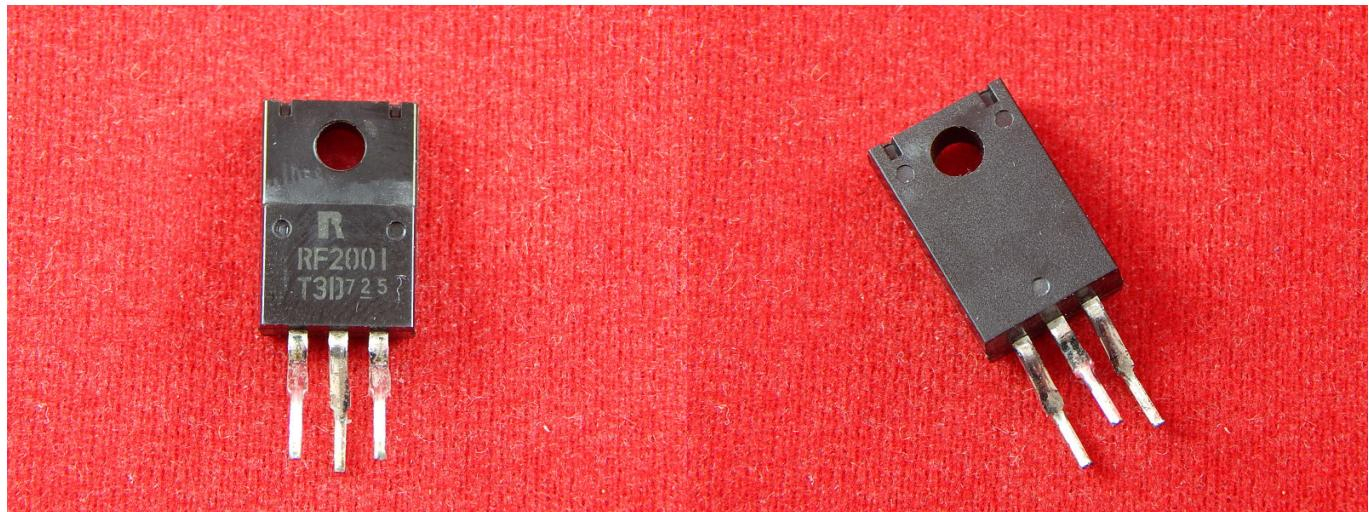
Диод — это полупроводниковое устройство, которое управляет током как однополюсный выключатель. Он позволяет току свободно проходить в одном направлении, но значительно ограничивает движение тока в противоположном направлении.
