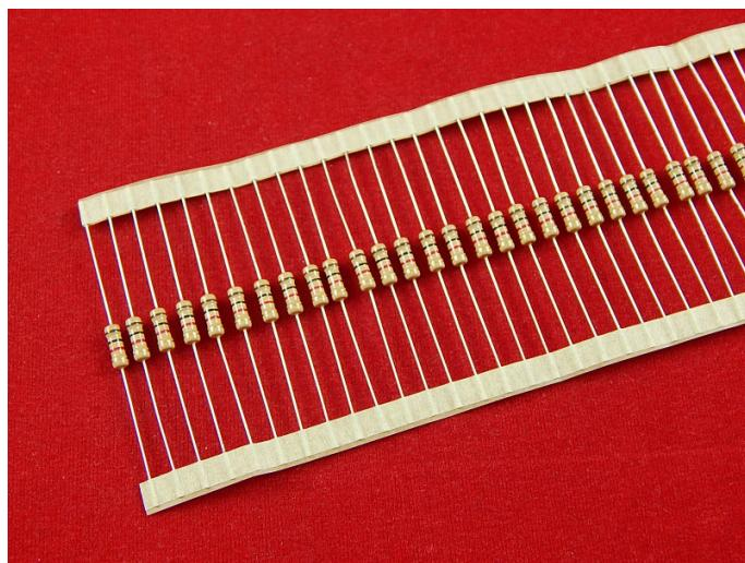
Резистор - это пассивный элемент электрических цепей, обладающий определённым или переменным значением электрического сопротивления, предназначенный для линейного преобразования силы тока в напряжение и напряжения в силу тока, ограничения тока, поглощения электрической энергии и другого. Весьма широко используемый компонент практически всех электрических и электронных устройств.
