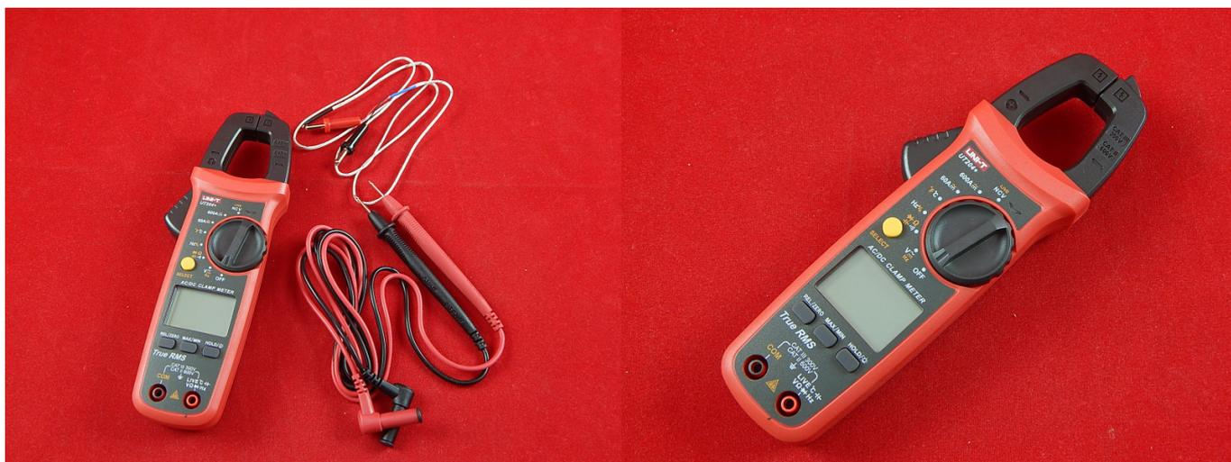
Токоизмерительные клещи — это прибор для измерения тока без разрыва цепи, в которой измеряется ток без контакта с ней. Принцип действия основан на измерении магнитного поля, порождаемого измеряемым током. Он сочетает в себе стандартный цифровой мультиметр и датчик тока.
