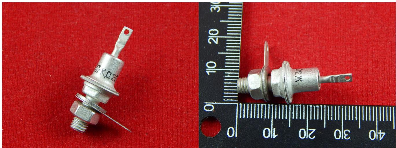
Диод – электронный прибор с двумя (иногда тремя) электродами, обладающий односторонней проводимостью. Электрод, подключенный к положительному полюсу прибора, называют анодом, к отрицательному – катодом.
