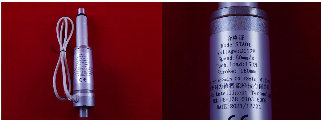
Актуатор 150мм (линейный привод) устроен таким образом, что вращательное движение двигателя постоянного тока преобразуется в линейное движение штока. Линейные приводы получили широкое применение в повседневной жизни. Данный вид можно использовать в инкубаторе для переворота лотков. Для организации реверсивного подключения потребуются электромагнитное реле.
