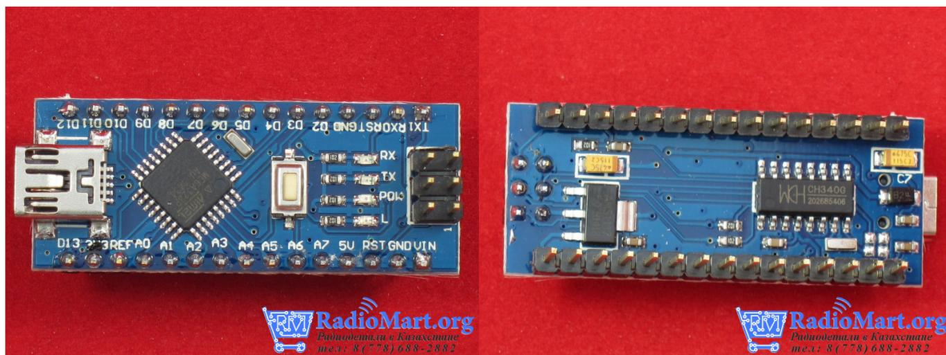
Платформа Nano, построенная на микроконтроллере ATmega328 и CH340G в качестве USB - RS232. Имеет небольшие размеры и может использоваться в лабораторных работах. Она имеет схожую с Arduino Duemilanove функциональность, однако отличается сборкой. Отличие заключается в отсутствии силового разъема постоянного тока и работе через кабель Mini-USB.
