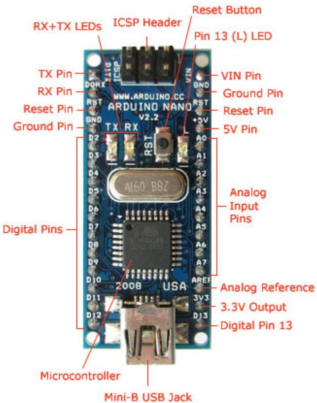
Каждый из 14 цифровых выводов Nano, используя функции [pinMode\(\)](#), [digitalWrite\(\)](#), и [digitalRead\(\)](#), может настраиваться как вход или выход. Выводы работают при напряжении 5 В. Каждый вывод имеет нагрузочный резистор (стандартно отключен) 20-50 кОм и может пропускать до 40 мА. Некоторые выводы имеют особые функции:
