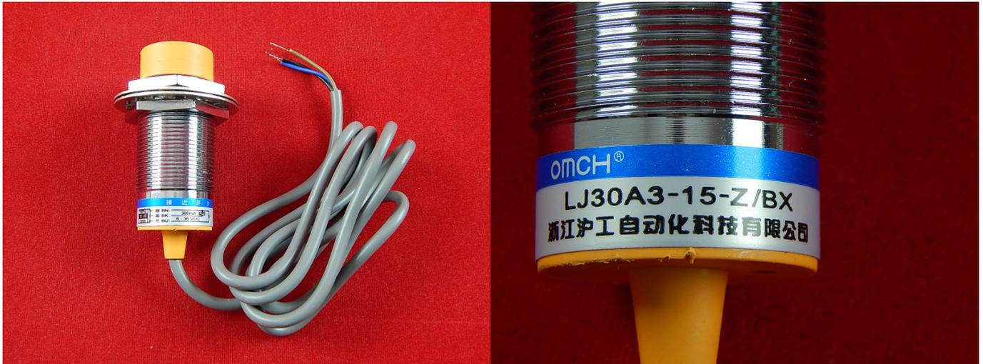
Индуктивный датчик LJ30A3-15-Z/BX предназначен для бесконтактного контроля положения предметов изготовленных из электро- и/или магнетопроводных материалов. Без физического контакта и вне зависимости от формы, индукционный бесконтактный датчик обнаруживает все предметы из цветных и черных металлов, находящиеся в пределах активной зоны, и выдает соответствующий управляющий сигнал.
