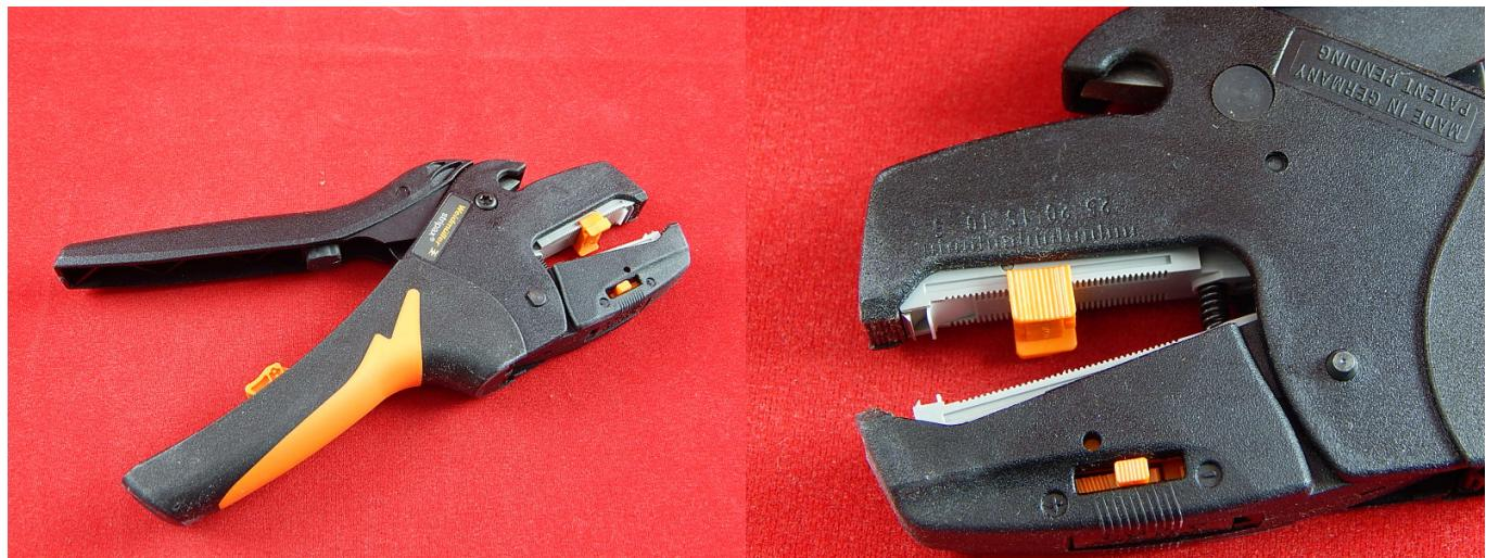
Стриппер - это инструмент для зачистки электропроводов с функцией обрезания проводов от Stripax 9005000000 предназначен для профессионального использования и имеет широкий диапазон настроек. Применяется для снятия изоляции с электропроводов. Регулировка длины реза значительно экономит время и упрощает работу пользователя.
