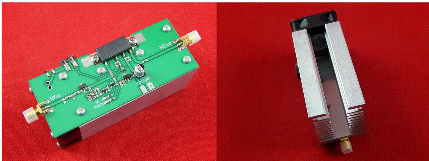
Радиочастотный усилитель мощности - это тип электронного усилителя, который преобразует маломощный радиочастотный сигнал в более высокий сигнал питания.
