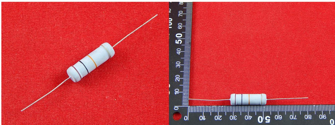
Резистор - это пассивный элемент электрических цепей, обладающий определённым или переменным значением электрического сопротивления, предназначенный для линейного преобразования силы тока в напряжение и напряжения в силу тока, ограничения тока, поглощения электрической энергии и другого.
