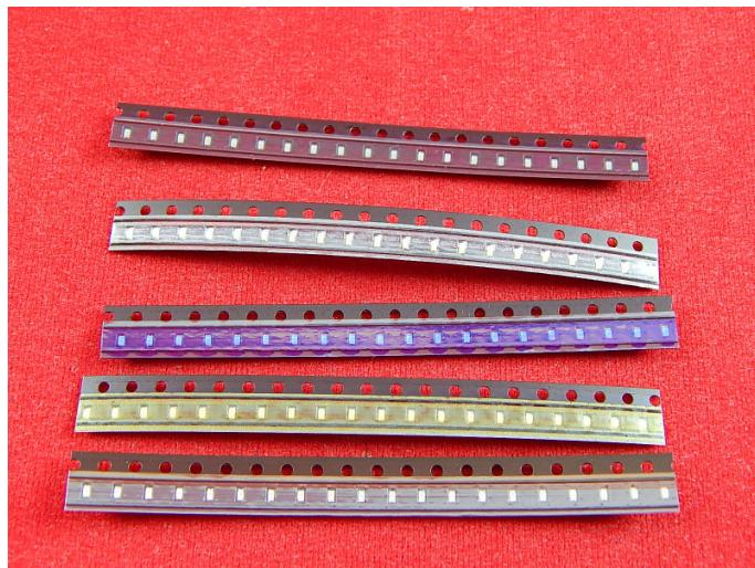
SMD светодиоды типоразмера 0603 - полупроводниковые источники света с прямым напряжением от 1.5 до 3.6 В и силой прямого тока от 5 до 20 мА.
