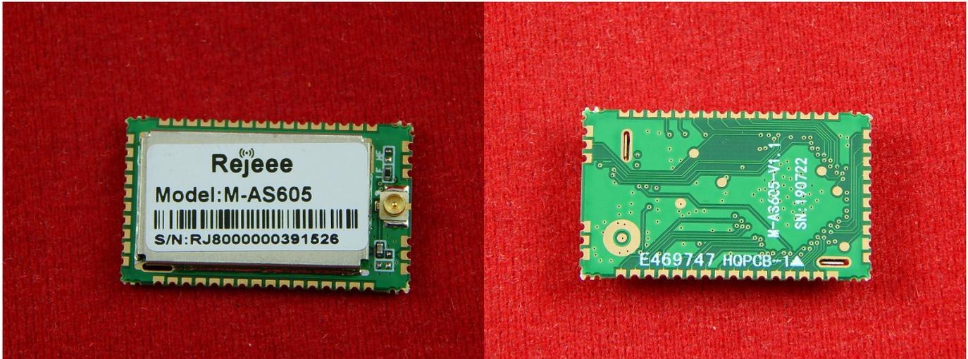
M-AS605 - это модуль LoRa нового поколения, разработанный на базе микросхемы ASR6505. Он объединяет маломощный микропроцессор STM8 и микросхему LoRa нового поколения SX1262, которые могут поддерживать внутренние и зарубежные диапазоны частот соответственно. Прошивка поддерживает протокол WaveMesh.
