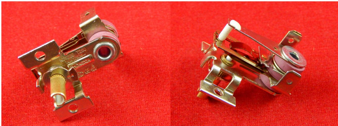
Биметаллический регулируемый термостат KST-017 с диапазоном регулирования от 100°C до +250°C. Имеет номинальный ток через контакты - 16А при 250В. А нормально-замкнутые контакты при достижении установленной температуры размыкаются.
