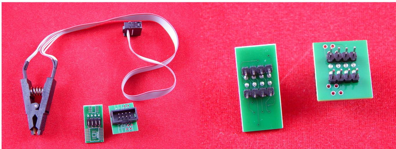
Прищепка для подключения к деталям в корпусе SOP8 без выпаивания
