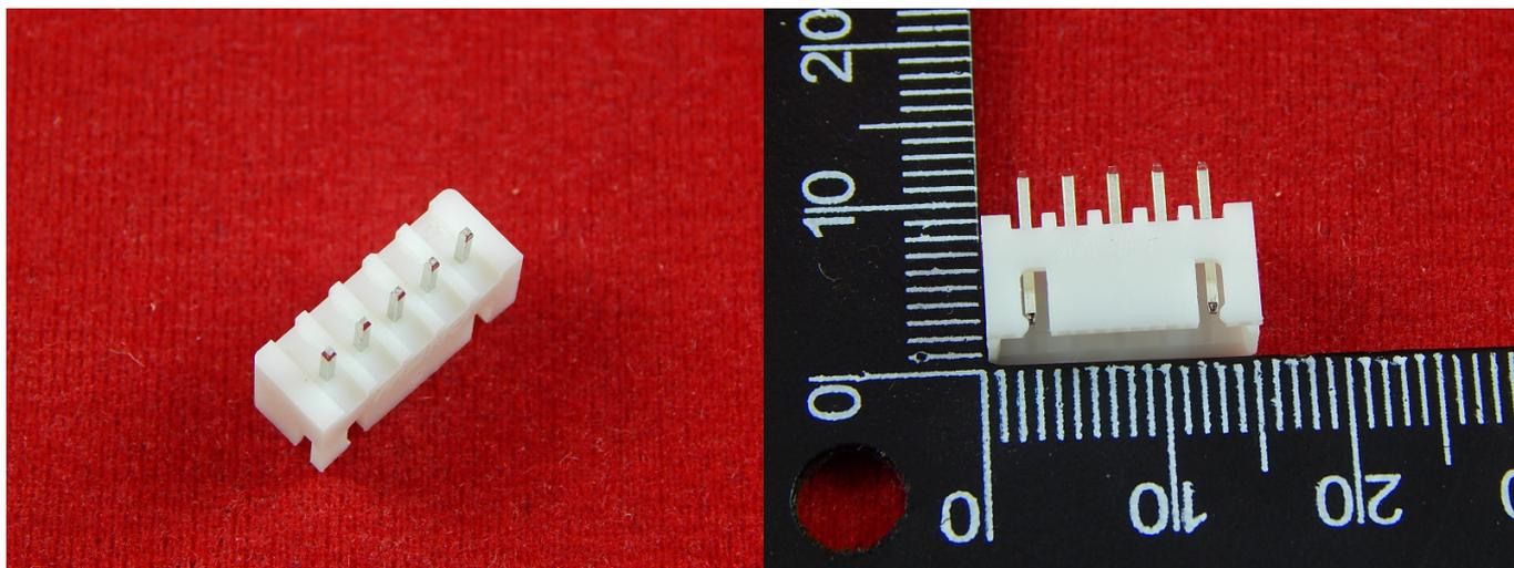
Разъем типа ХН применяют в радиоэлектронике, компьютерной технике, устройствах собранных на Arduino, в 3D принтерах на платах MKS, KFB. Так же ХН используется при подключении вентиляторов, для подключения и быстрой замены аккумуляторной батареи, для подключения светодиодов и светодиодных лент, динамиков, термисторов, конечных выключателей, шаговых двигателей и прочей периферии.
